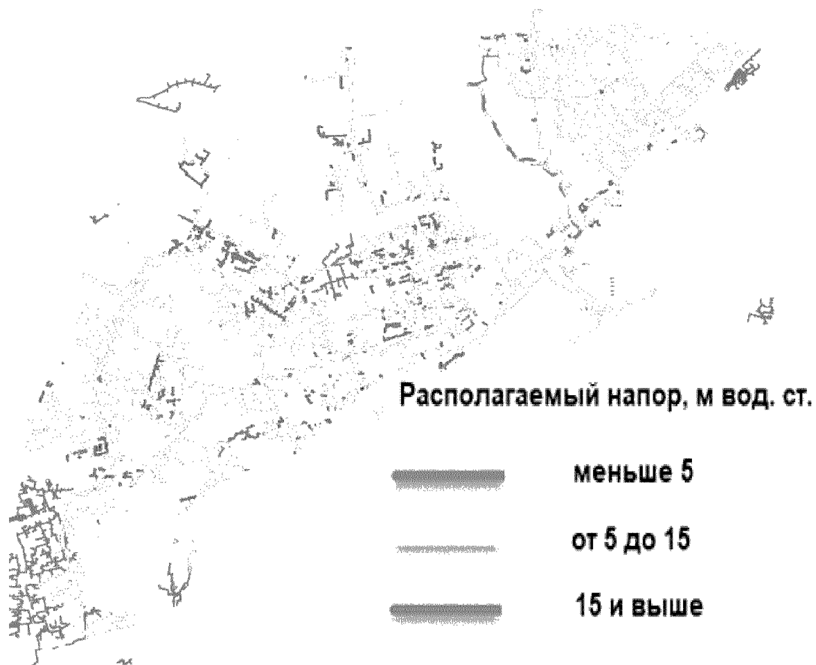
Рисунок 46 – Графическая интерпретация с располагаемым напором систем теплоснабжения
